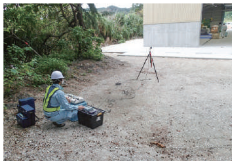
■騒音・振動調査状況
