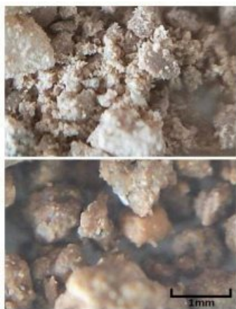
写真 1 改良前(上)と改良後(下)の赤土
