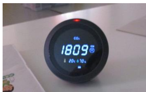
図5 換気不十分の保育室(CO 2 メーター)
