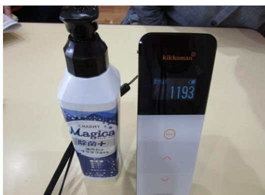
図4 テーブル洗浄後のATP測定 (洗浄前:152,531 RLU 洗浄後:1,193 RLU)
